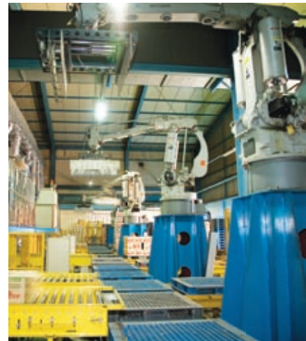
최종 생산된 제품이 파렛타이저(Palletizer)를 통해 적재되는 모습
